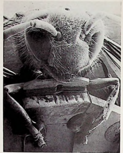
Bild 6: Dünner als Wespenfüße sind die Wicklungen des Videokopfes
